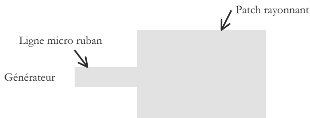
Figure 4.18 – Alimentation par ligne micro ruban.
