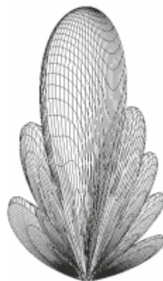
Figure 4.2 – Exemple de diagramme de rayonnement 3D en valeurs logarithmiques.
