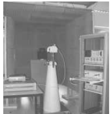
Figure 10.2 – Chambre anéchoïque pour la mesure d'antennes
