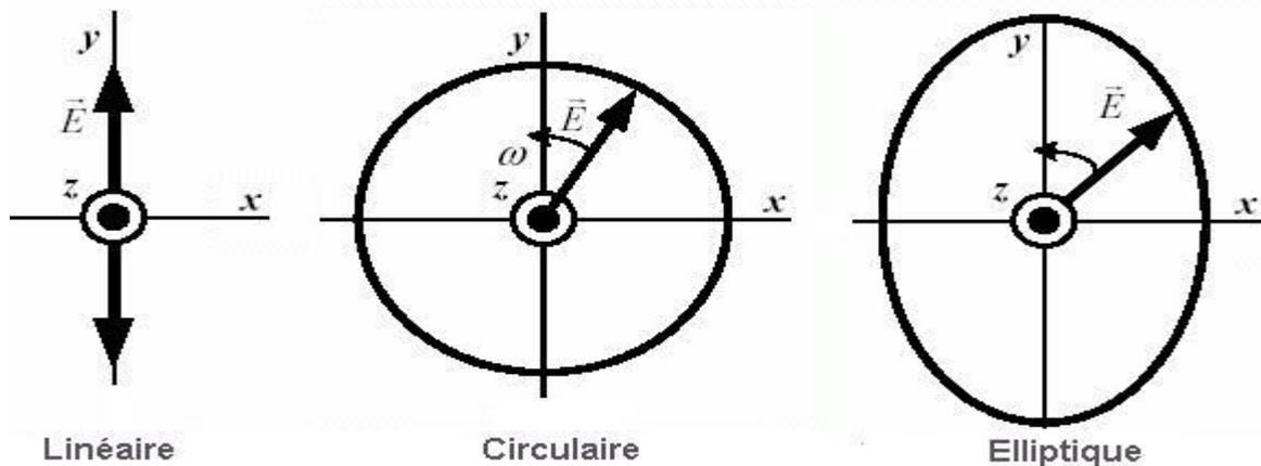
1. Une onde plane est dite à polarisation rectiligne si le champ électrique est constamment dirigé dans la même direction.
