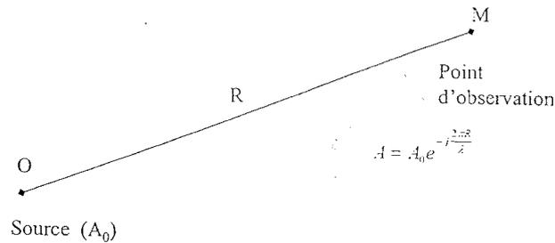
$A_0$  et  $A$  étant les amplitudes complexes de la source O et du point M.
