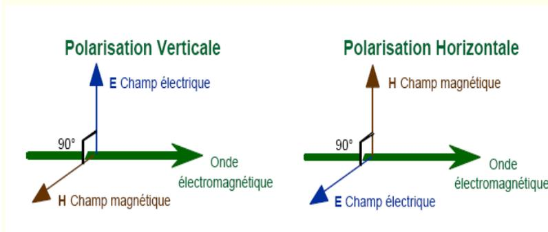
Par convention, le plan de polarisation est défini selon l'orientation du champ électrique. Lorsque la configuration de l'antenne place le champ électrique verticalement, on dit que la polarisation est verticale. À l'inverse, lorsque la configuration de l'antenne place le champ électrique horizontalement, on dit que la polarisation est horizontale. Dans certaines conditions, la polarisation peut être aussi "circulaire droite ou circulaire gauche".
