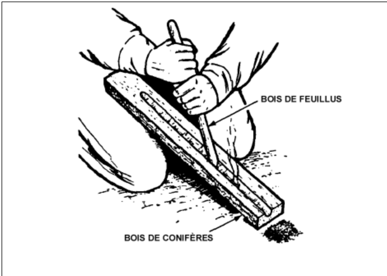
Figure 7-7 : La méthode par frottement
