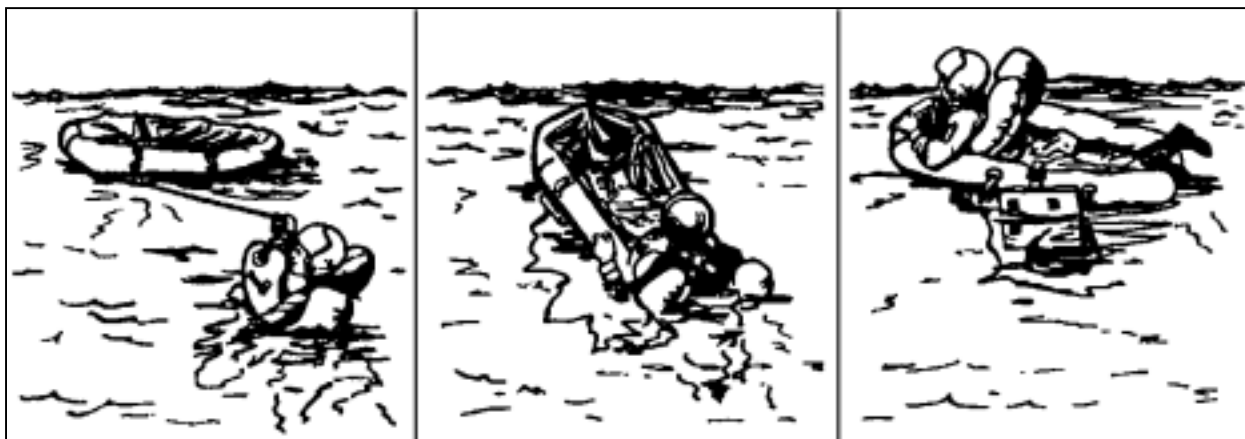
Figure 16-9 : Comment monter dans un radeau monoplace
