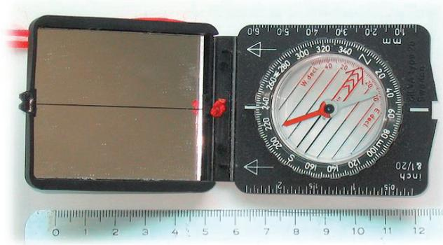
**SILVA TYPE 26****Poids :** 24 gr**Longueur :** 68 mm**Largeur :** 59 mm**Hauteur :** 15 mm**Modèle :** pliant**Prise d'azimut :** à miroir**Règle :** 1:20ème et inch**Règle :** 6 cm**Bord droit :** de 6 cm**Graduation :** 360 ° (2en2)**Correction de déclinaison :** +60-60**Divers :** pas de traits de repérage fluorescents , pas de clinomètre**Capsule :** mobile**Prix moyen :** 20 €**Indication :** aiguille
