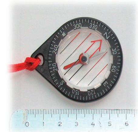
**SILVA TYPE 12****Poids :** 11 g**Longueur :** 55 mm**Largeur :** 45 mm**Hauteur :** 19 mm**Modèle :** type porte-clés**Prise d'azimut :** non**Règle :** non**Bord droit :** aucun**Graduation :** 360 ° (5en5)**Divers :** pas de correction de déclinaison, pas de traits de repérage fluorescents , pas de clinomètre**Capsule :** mobile**Prix moyen :** 18 €**Indication :** aiguille
