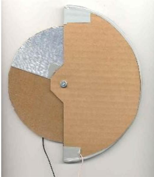
Du papier d'alu, un film plastique et du carton. On fait varier la surface des plaques qui se font face, et donc la capacité du condensateur.
